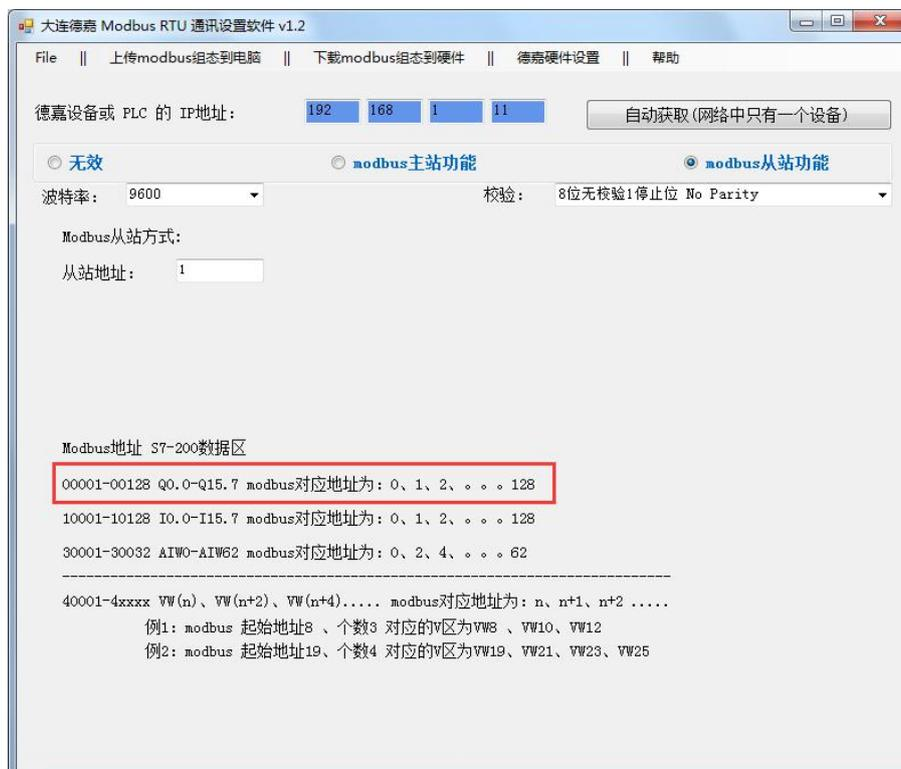
主站（B 点）M02 型 PLC 内嵌 Modbus 相关参数设置如下：波特率：9600；校验方式：8 位无校验、1 停止位、No Parity；命令重发次数：从站无响应，直接发送下一条命令；等待从站回答时间：500ms；并下载 Modbus 组态到硬件。
